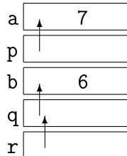
*Операция разыменования* — получение значения ячейки памяти по её адресу, на рисунке разыменованию соответствует один проход по стрелке. Операция разыменования обозначается символом `*` слева от разыменуемого адреса. В примере выше выражение `*p` имеет значение 7, выражение `*q` — 6, а выражение `*r` равно адресу переменной `b` (таким образом, `**r` имеет значение 6).
